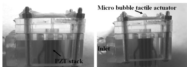
(a) Bubble actuator OFF (b) Bubble actuator ON
